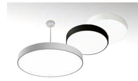
RUNDO IP20 Mått: ø 400-1150 mm Ljusflöde: 1120-23900 lm Funktion: On/off, DALI/SwitchDim, Sensor Ra (CRI): >80
