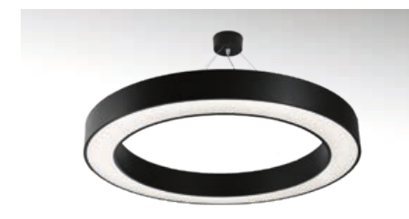
ROTA IP20 Mått: \varnothing 600-3000 mm Ljusflöde: 2090-25390 lm Funktion: On/off, DALI/SwitchDim Ra (CRI): >80, >90
