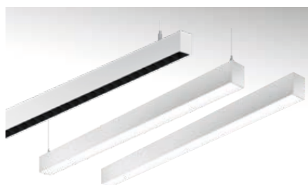
LINE IP40 IK04 Mått: 568-2266 mm, rampbar Ljusflöde: 899-14289 lm Funktion: On/off, DALI/SwitchDim, Dragdim Ra (CRI): >80, >90
