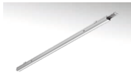
LINÉA IP40 IK06 Mått: 1680, 3360 mm Ljusflöde: 2150-21000 lm Funktion: On/off, DALI/SwitchDim Ra (CRI): >80
