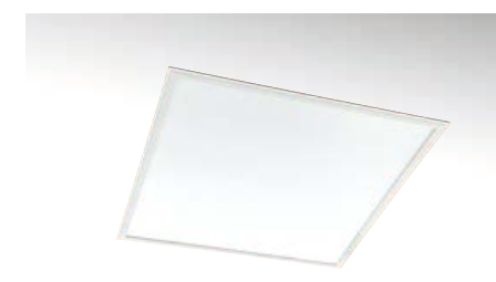
RUNO IP40 Mått: 595x595x11 mm Ljusflöde: 4392-4732 lm Funktion: DALI/SwitchDim Ra (CRI): >80
