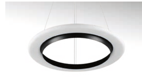
JORUND IP40 Mått: ø 630, 970 mm Ljusflöde: 2100-5600 lm Funktion: On/off, DALI/SwitchDim Ra (CRI): >80
