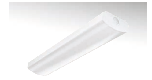
BRUNN S IP44 IK07 Mått: 601, 1161 mm Ljusflöde: 2100-4450 lm Funktion: On/off, DALI/SwitchDim, Sensor Ra (CRI): >80
