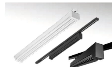
TERJE SKENA IP20 Mått: 570, 630, 1120, 1180 mm Ljusflöde: 1050-6300 lm Funktion: On/off, DALI/SwitchDim Ra (CRI): >80
