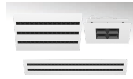
MINO IP20 IK04 Mått: Flertal olika utföranden Ljusflöde: 542-7423 lm Funktion: On/off, DALI/SwitchDim Ra (CRI): >80
