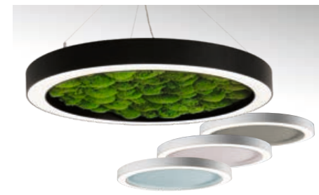
ROTA AKUSTIK IP20 Mått: ø 600-1500 mm Ljusflöde: 2090-10880 lm Funktion: On/off, DALI/SwitchDim Ra (CRI): >80, >90
