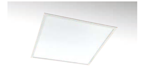
RUNO IP40 Mått: 595x595x11 mm Ljusflöde: 4392-4732 lm Funktion: DALI/SwitchDim Ra (CRI): >80
